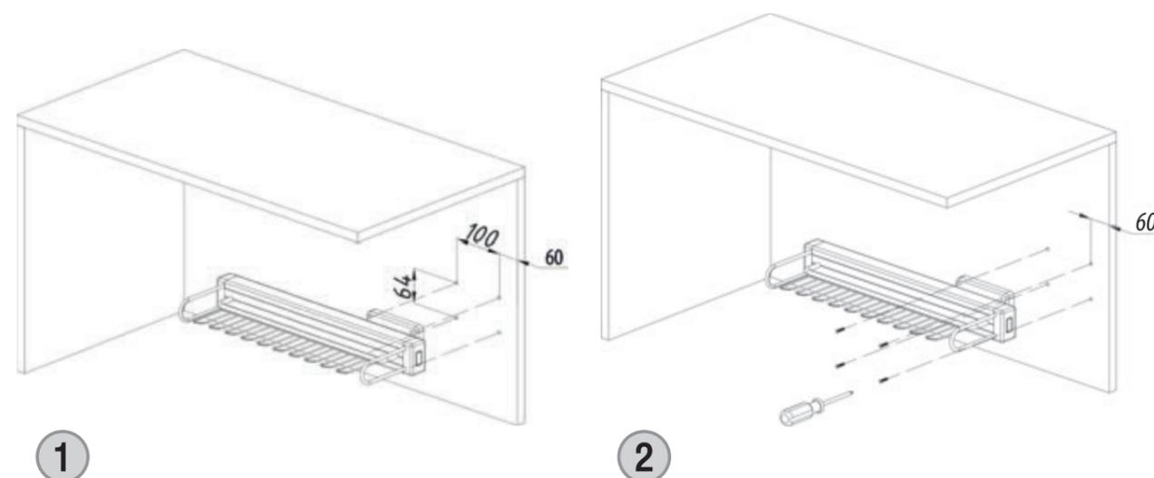
**1** Делаем разметку под присадку (см. рисунок) с обеих сторон. Сверлим «слепые отверстия» глубиной не менее 8мм.
