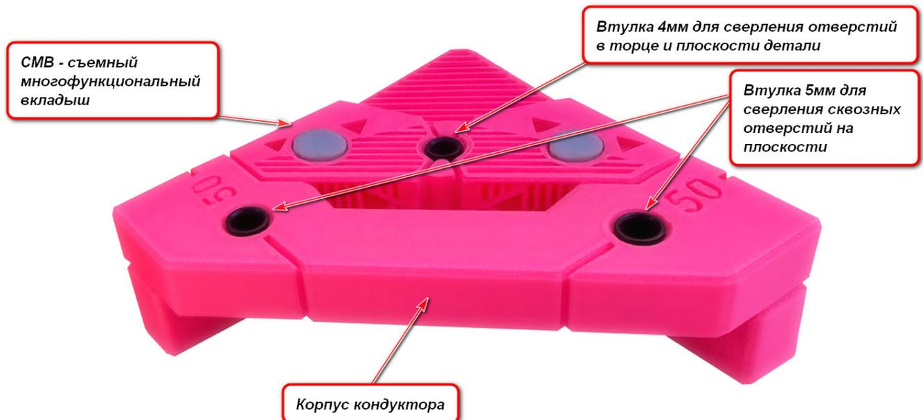
На съемном многофункциональном вкладыше с двух сторон расположены выступающие круглые силиконовые площадки. Создавая повышенное трение, они фиксируют кондуктор на плоскости или на торце обрабатываемой детали.
