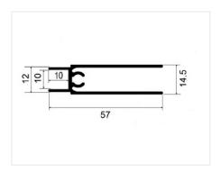
На концах профиля на расстоянии 50мм +/- 10% находятся контактные пятна!
