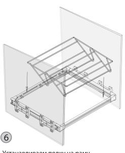
Устанавливаем полку на раму и фиксируем с помощью крепежей.
