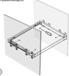
Регулируем по ширине модуля, затем фиксируем. Закрепляем винтами (E) в углах рамы.
